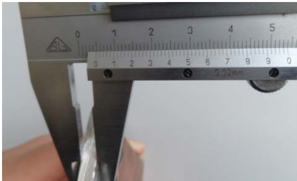
铜铝复合排 6mm×40mm 铝层厚度照片 (4.9mm)
