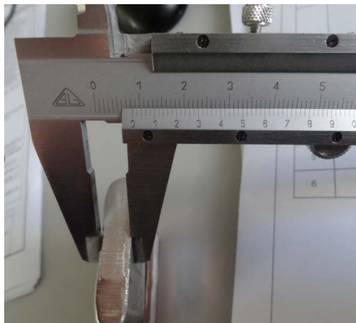
铜铝复合排 10mm×40mm 铝层厚度照片 (8.5mm)
