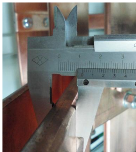
主开关进出线厚度（12mm）照片
