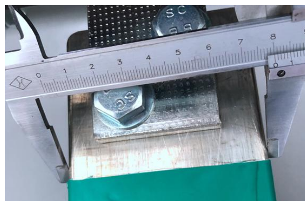
主母排宽度照片
